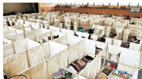
避難所用紙製簡易間仕切りシステム 写真：Voluntary Architects' Network
